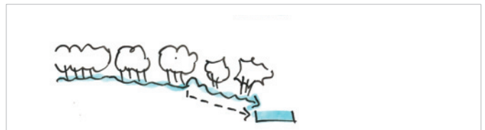
Lättibach Schnitt Zukunft: Bach offen, Hochwasserüberlauf unterirdisch
