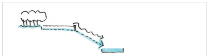
Lättibach Schnitt Bestand: Bach eingedolgt, Hochwasserüberlauf oberirdisch
